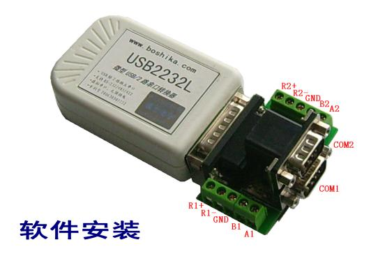
USB2232L 配套有一根 1 米长的 USB 延长电缆和驱动软件(一张光盘)。驱动程序支持 Windows7/ me/2000/XP、LINUX、iMAC 等,但是与波仕 USB232 的驱动软件不同。
