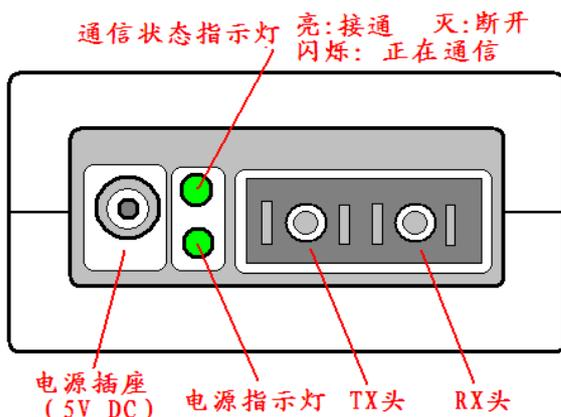
图2 光口以及通信状态指示灯
