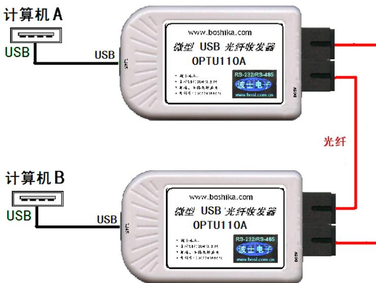
图 6 计算机 USB 光纤组网通信
